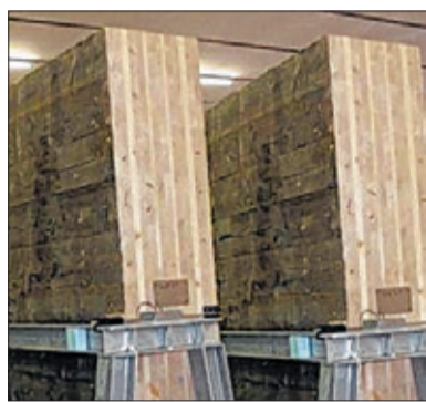
Mit Brettsper Holzplatten wie diesen wird die Grundkonstruktion der Holzwindräder verkleidet. Foto: Timber-Tower
